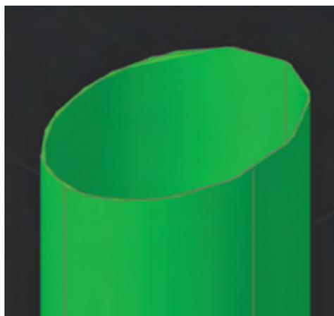
Рис. 2.18. Вычитание цилиндров
