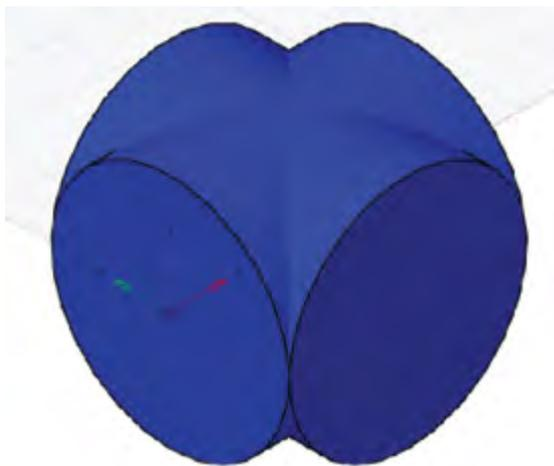
Рис. 2.40. Пересечение цилиндров
